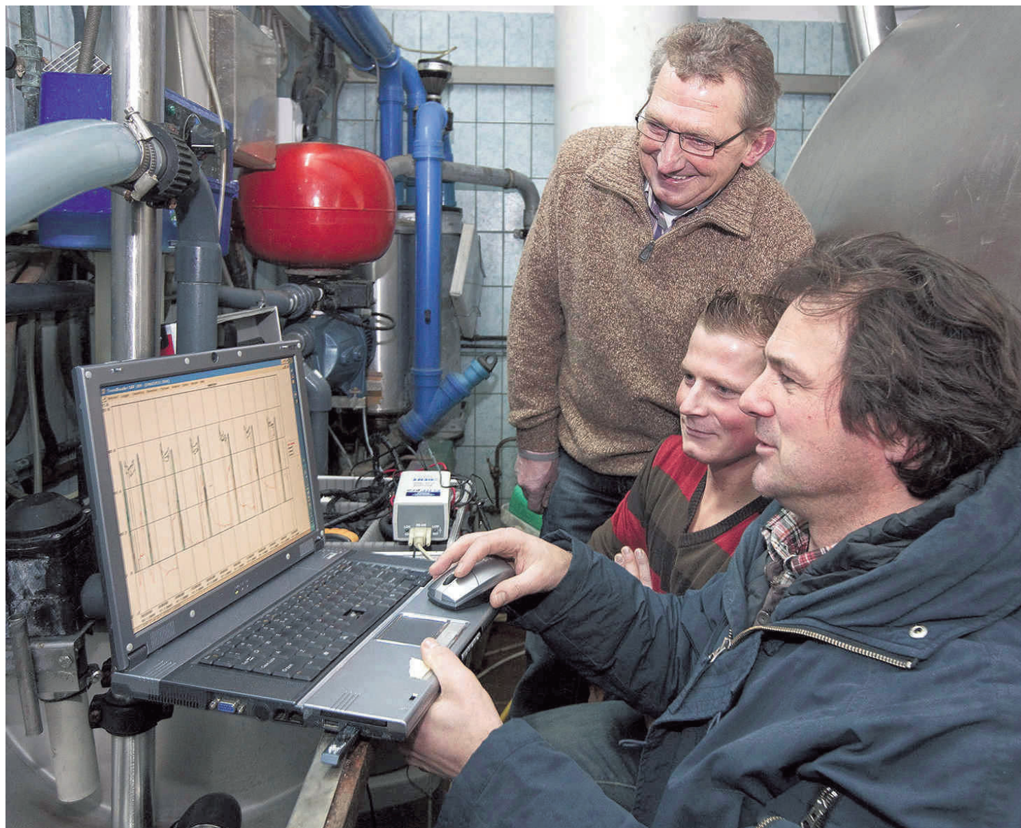
Rob Jacobs (rechts) meet het energieverbruik van de melkinstallatie. Op zijn laptop laat hij de uitkomsten zien aan Harm (links) en Steven van der Weerd.
